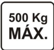
Carga máxima da concha é de 500 kg. Ultrapassar o limite causará danos e redução da vida útil do equipamento.
