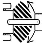
Ao efetuar manobras ou curvas fechadas fique atento para evitar que a roda do trator toque o cabeçalho do equipamento.
